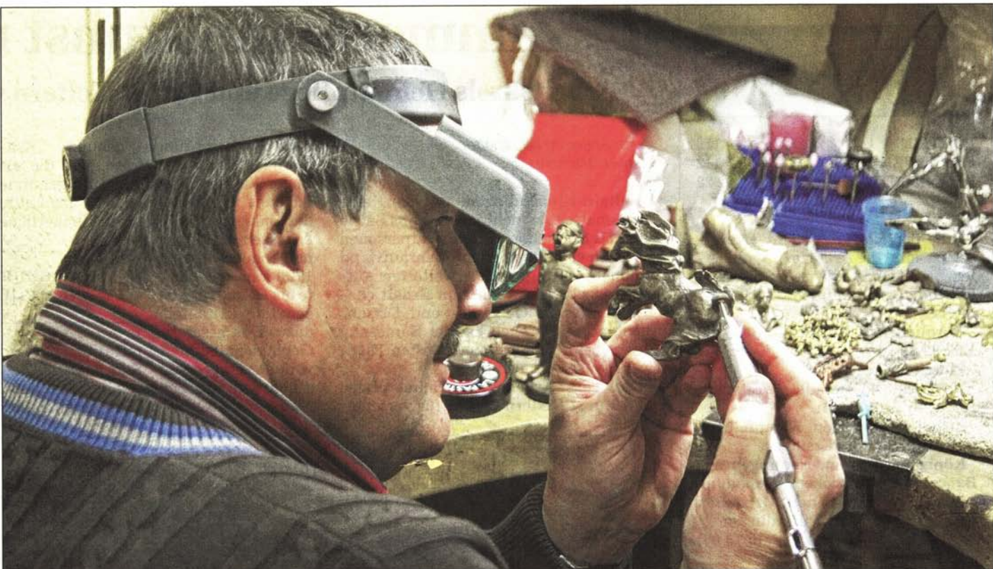
FINGERSPITZENGEFÜHL GEFRAGT: Auch nach dem Kunstguss wird die Figur noch sorgfältig bearbeitet, bis sie die gewünschte Oberfläche hat. Filigrantechnik im Sandgussverfahren ist ein aussterbendes Handwerk. Fotos: Hansen
